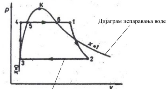
Основни теоријски циклус по којем раде парнотурбинска постројења (Ранкин-Клаусијусов циклус)
